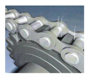
Une lubrification optimale contribue à diminuer la friction et donc l'usure des chaînes.
