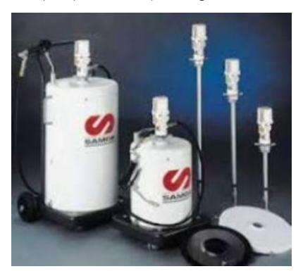
Un graissage efficace nécessite une pompe capable de délivrer une pression suffisante pour pousser la graisse à travers l'ouverture très étroite du point de graissage. C'est pour cette raison que les pompes utilisées ont un ratio et une pression élevés.
