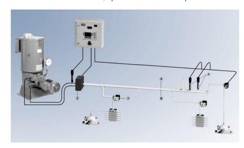
La pompe centrale est reliée à un inverseur de pression par une conduite sous pression et une conduite de retour.
